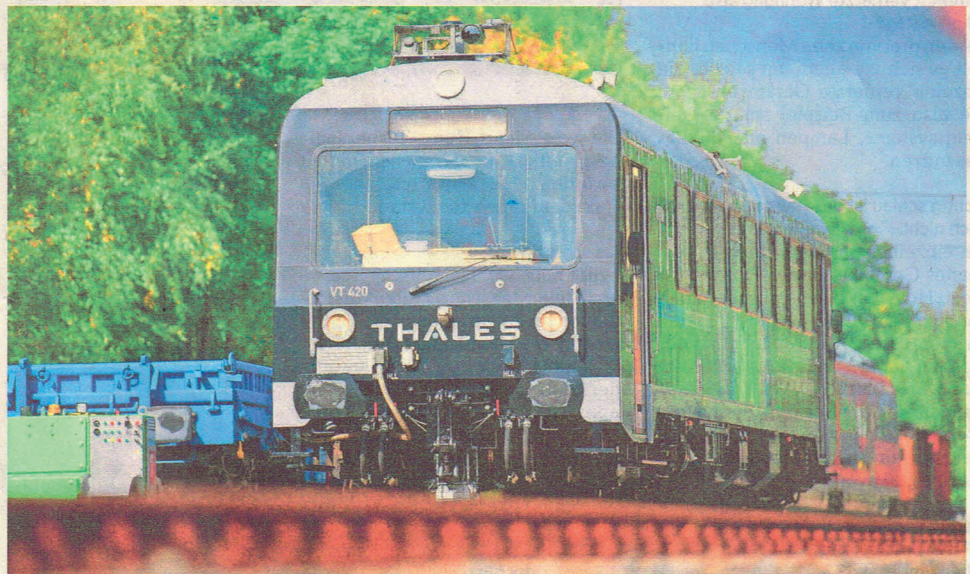
Sachsen, Schlettau: Ein Triebwagen des Militär- und Transportunternehmens Thales ist auf einer Testfahrt im Bahnhof Schlettau unterwegs. Der Zug wird über den neuen Mobilfunkstandard 5G ferngesteuert.
